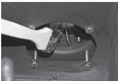
Fig. 70 Gebläserad reinigen und aussaugen
