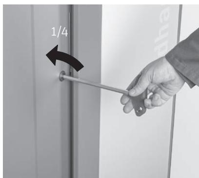
Fig. 4 Verkleidungstür mittels Innensechskantschlüssel öffnen
