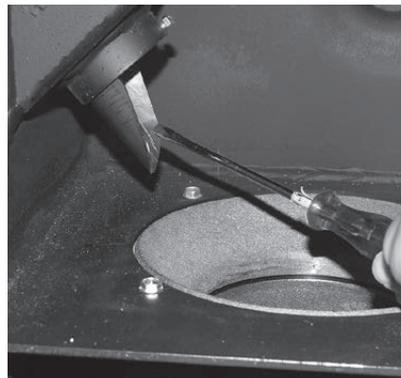
Fig. 49 Fallrinne reinigen
