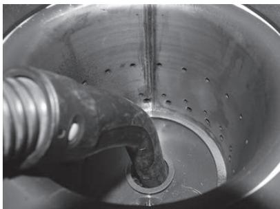
Fig. 59 Primärluftrohr in der Mitte des Brennerkopfes aussaugen
