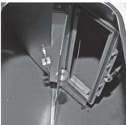
Fig. 84 Klappe Zuführreinheit
