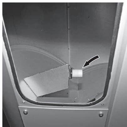
Fig. 85 Näherungsschalter Zuführreinheit
