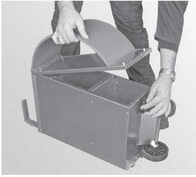
Fig. 46 Spannbügelverschlüsse öffnen, Deckel abnehmen und Aschebox entleeren
