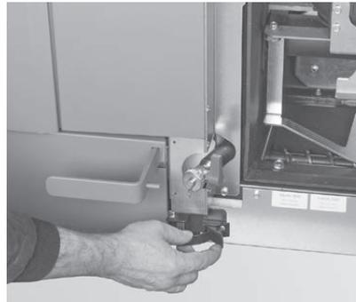
Fig. 43 Spannbugelverschluss öffnen
