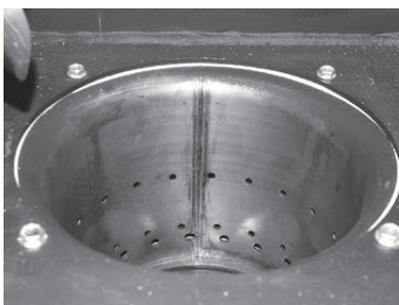
Fig. 58 Sekundärluftlöcher im Brennertopf reinigen
