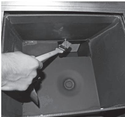
Fig. 48 Thermocontrol-Fühler reinigen
