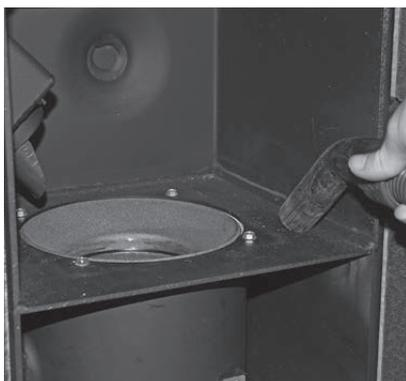
Fig. 50 Verbrennungsrückstände aus dem Brennraum entfernen
