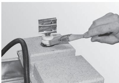
Fig. 71 Elektrode reinigen (nur bei Pelletskessel mit elektrostatischem Staubabscheider)
