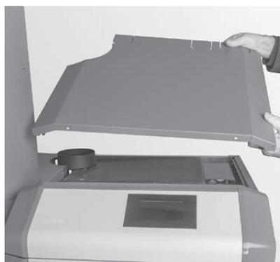
Fig. 78 Abdeckung oben abheben
