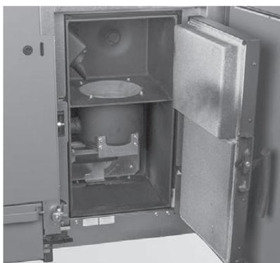
Fig. 37 Verkleidungstür und Brennraumtür öffnen
