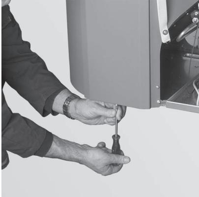
Fig. 81 Schrauben entfernen
