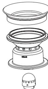
Fig. 60 Konus Oberteil und Unterteil, Primärluftdorn
