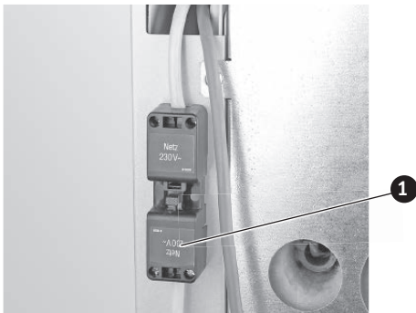
Fig. 57 Netzstecker abstecken 1.....Netzstecker
