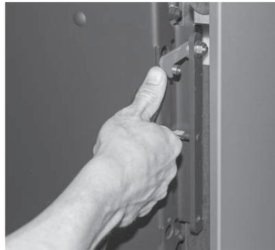
Fig. 7 Fülltür-Sperre öffnen
