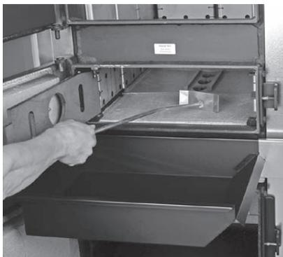
Fig. 8 Aschelade einhängen, Asche entfernen
