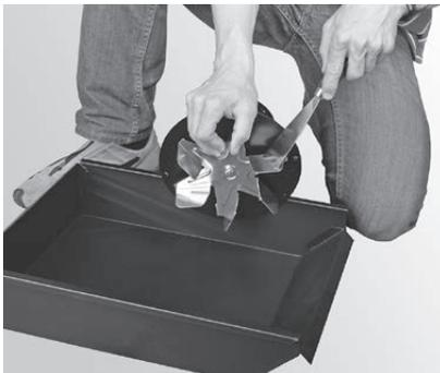
Fig. 36 Gebläserad reinigen
