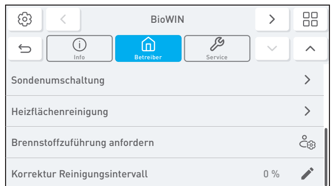
Fig. 91 Betreiberebene Pelletskessel, Anzeige bei Zuführsystem
