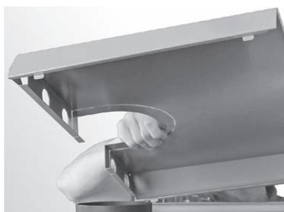
Fig. 85 Retirer le capot arrière de la chaudière
