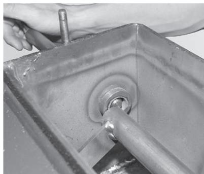
Fig. 39 Insérer l'arbre dans l'axe de la tringlerie
