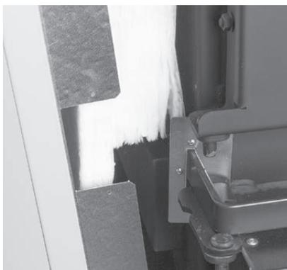
Fig. 48 Ouvrir l'orifice prédécoupé
