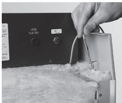
Fig. 54 Insérer la sonde Thermocontrol en haut
