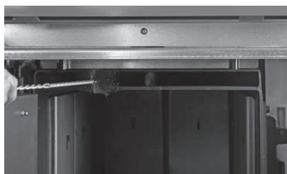
Fig. 33 Nettoyer le système d'aspiration des gaz
